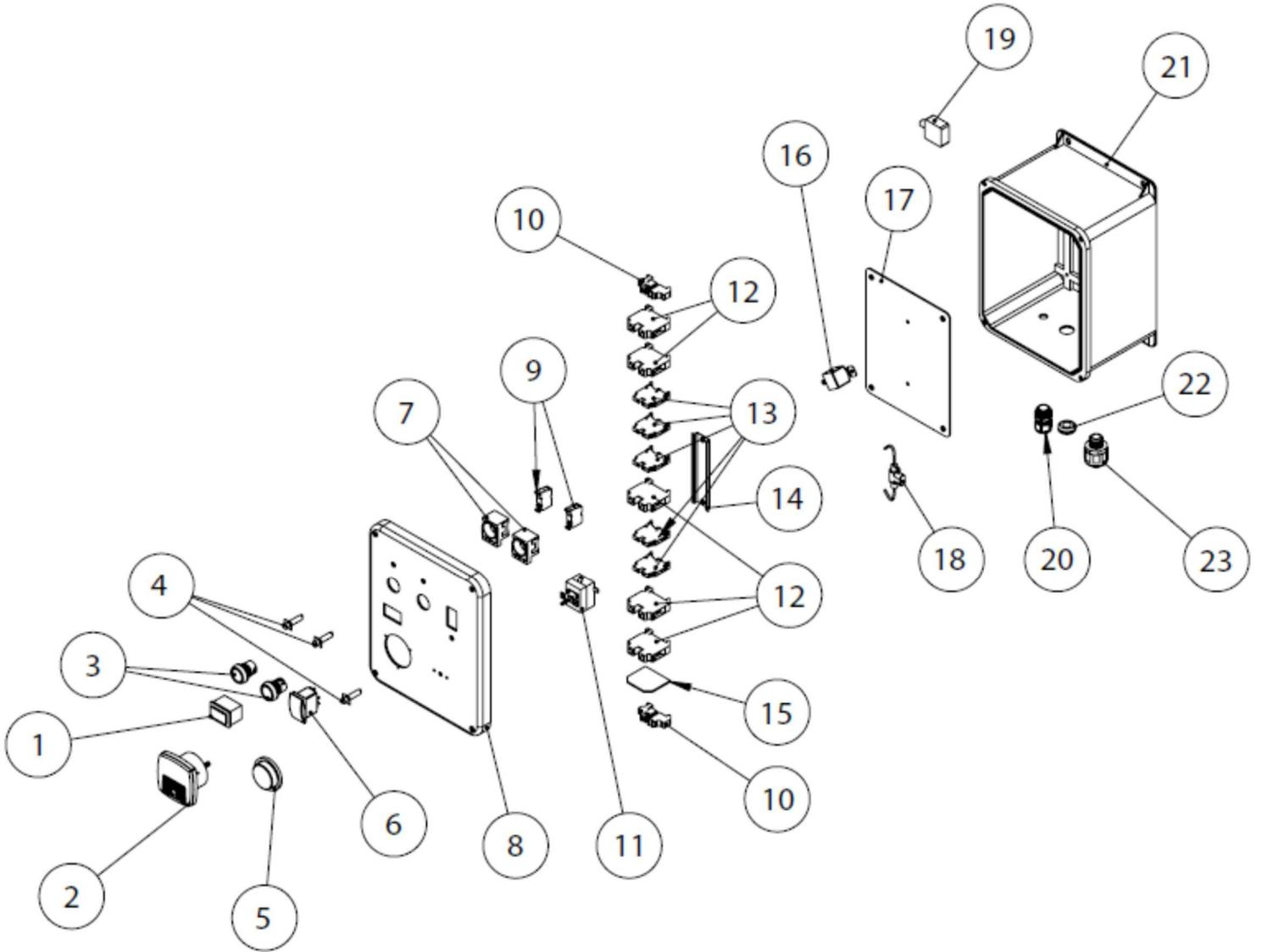
**Parts Breakdown HV690FLS-12V CONTROL BOX**
